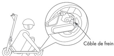
Si le frein est trop lâche, utilisez la clé Allen 4mm pour desserrer la vis de l'étrier. Ensuite, ajustez légèrement la conduite de frein (augmenter la longueur exposée) et resserrer la vis.
