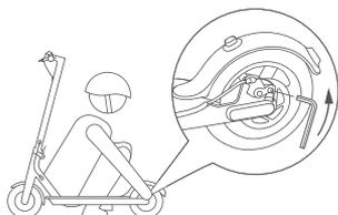
Si le frein est trop serré, utilisez la clé Allen 4mm pour desserrer la vis de l'étrier. Ensuite, ajustez légèrement la conduite de frein (diminuer la longueur exposée) et resserrer la vis.
