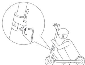
Une utilisation prolongée du scooter peut entraîner un desserrage des vis et rendre la tige du guidon instable. Si vous remarquez que la potence du guidon est instable ou lâche lorsque vous roulez, utilisez la clé Allen de 4 mm pour serrer les vis du mécanisme de maintien.
